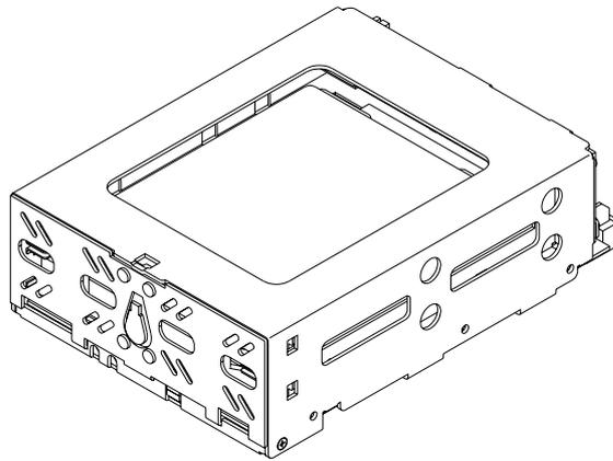
8. Mirror Driveをホスト・コンピュータに組み込み、SCSIケーブルおよび4ピン内蔵用電源ケーブルを接続してください。
