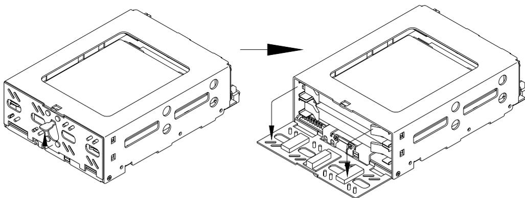
6. 各ドライブ・ユニットのドライブレバーを両手で手前に引いて、ドライブ・ユニットを引き抜いてください。
