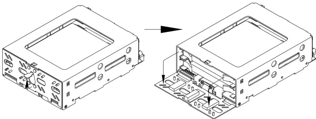
5. 各ドライブ・ユニットのドライブ・レバーを両手で手前に引いて、ドライブ・ユニットを引き抜いてください。
