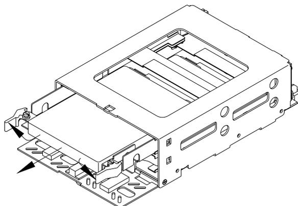
6. 交換用ドライブ・ユニットのドライブ・レバーを閉じた状態で、両手でしっかりとドライブ・ベイの奥まで押し込んでください。
