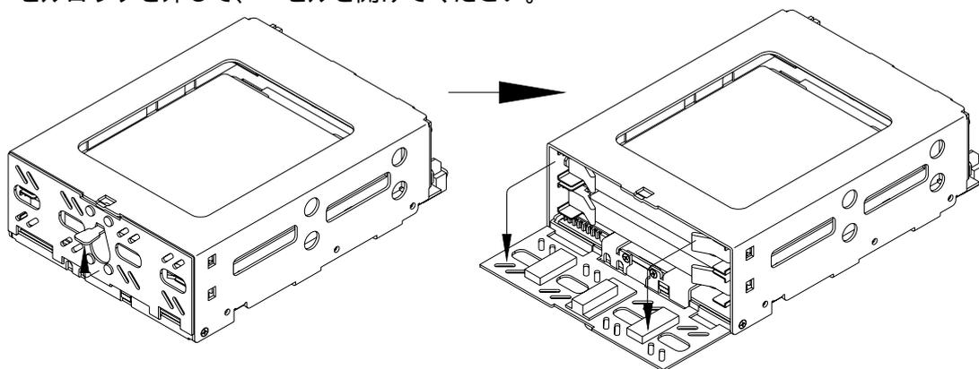
5. 故障したドライブ・ユニットのドライブ・レバーを両手で手前に引いて、ドライブ・ユニットを引き抜いてください。
