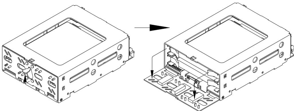
12. 交換用ドライブ・ユニットを空いたドライブ・ベイへドライブレバーを閉じた状態で両手でしっかりとドライブベイの奥まで押し込んでください。
