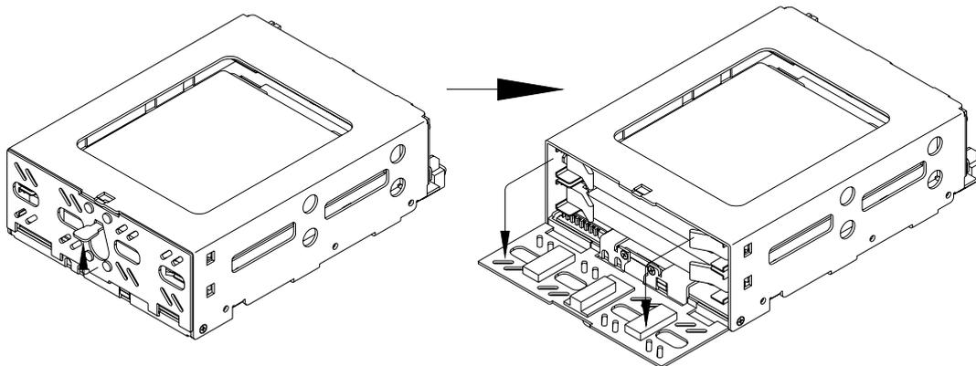
4. 最初に故障したと思われるドライブ・ユニットのドライブ・レバーを両手で手前に引いて、ドライブ・ユニットを引き抜いてください。
