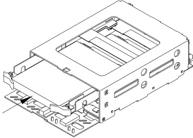
8. ドライブ・ユニット交換から数秒後に、交換したドライブ・ユニットのドライブ・ステータス・インジケータが緑色に点灯し、アクセス・インジケータが橙色に点滅し、データの再構築が始まります。
