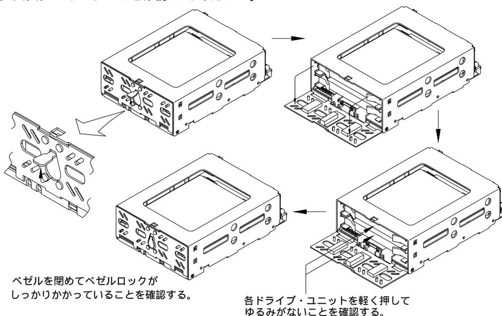
その後、ホスト・コンピュータの電源を投入し、本製品がホスト・コンピュータから正しく認識できるか確認してください。
