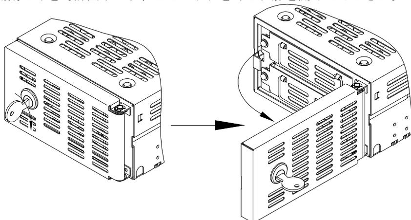
5. 各ドライブ・ユニットの左側にあるドライブ・ユニット固定用ネジを反時計回りにドライバーで完全にネジ部を外してください。ただし、ドライブ・ユニット固定用ネジは、ストッパーによりドライブ・ユニット本体から取り外せません。
