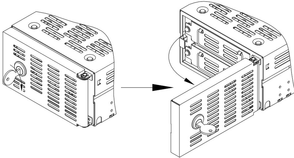
5. 故障したドライブ・ユニットの左側にあるドライブ・ユニット固定用ネジを反時計回りにドライバーで完全にネジ部を外してください。ただし、ドライブ・ユニット固定用ネジは、ストッパーによりドライブ・ユニット本体から取り外せません。
