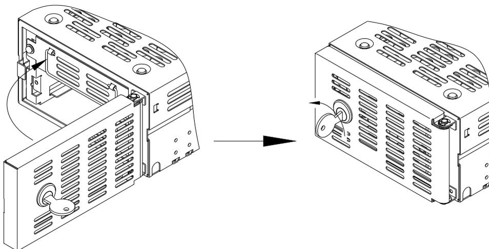
10. **Mirror Drive** をホスト・コンピュータに組み込み後、IDE (ATA) ケーブルおよび4ピン内蔵電源ケーブルを接続してください。
