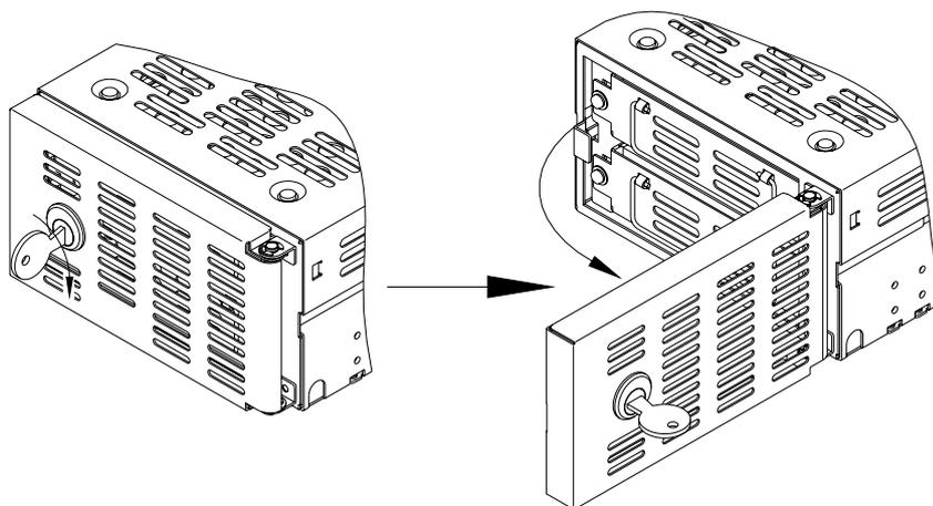
4. ドライブ・ユニットの左側にあるドライブ・ユニット固定用ネジを反時計回りにドライバーで完全にネジ部を外してください。ただし、ドライブ・ユニット固定用ネジは、ストッパーによりドライブ・ユニット本体から取り外せません。
