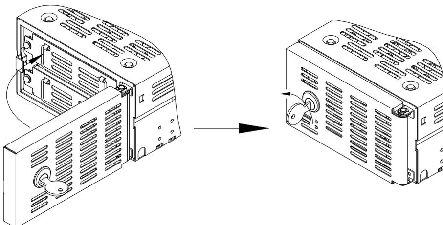
9. ドライブ・ユニット交換後、数秒後に交換したドライブ・ユニットのドライブ・ステータス・インジケータが橙色に点灯し、データの再構築が始まります。
