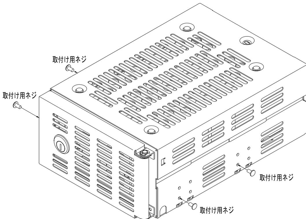
側面の取付け用ネジ穴を使用した場合
