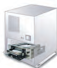
5.25型のオープンベイにホットスワップ型のミラードライブが搭載可能
